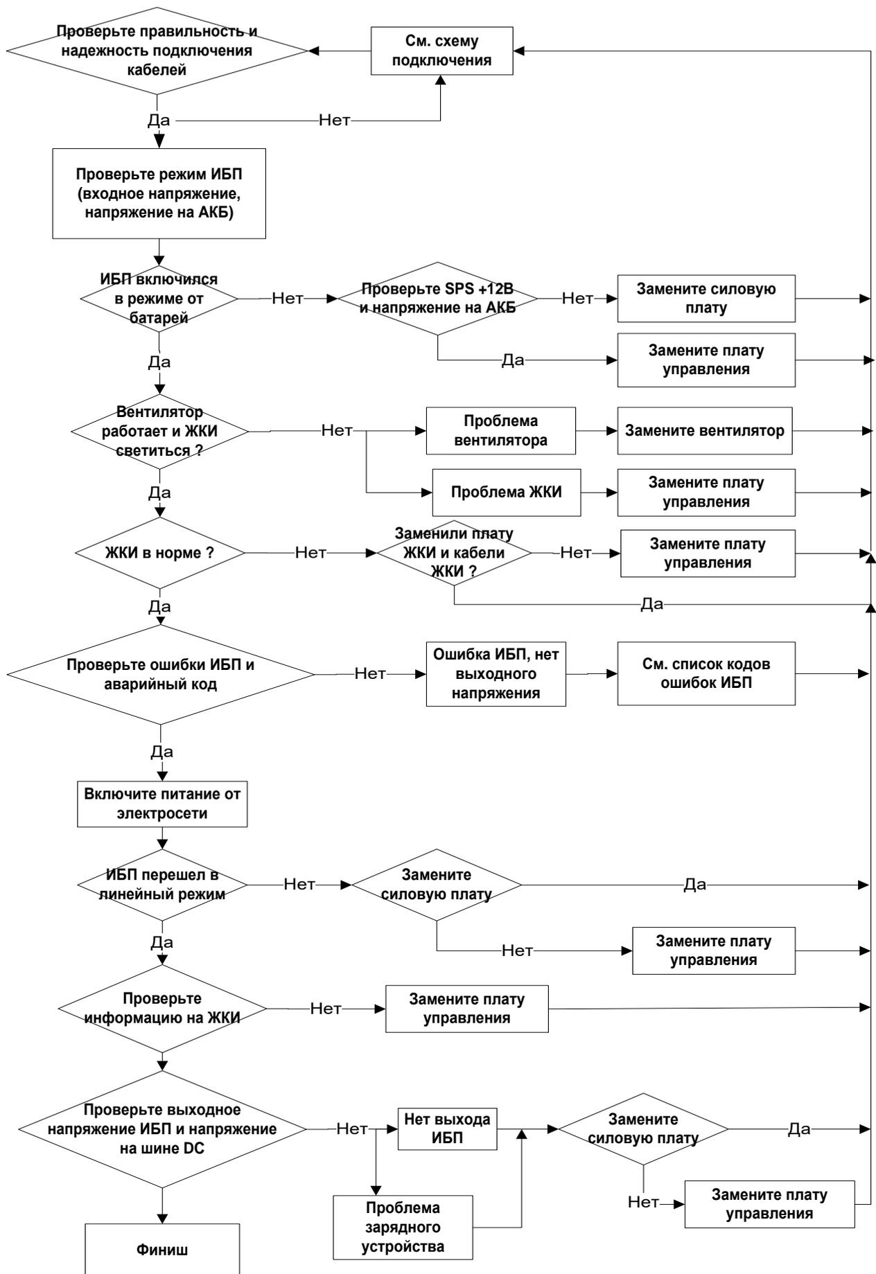
Схема поиска неисправности
