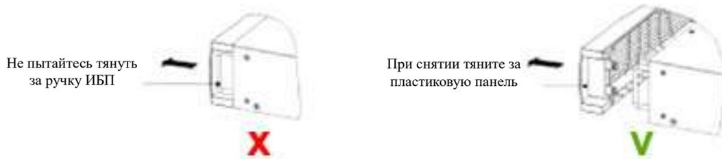
Рисунок 5 Снятие передней панели
