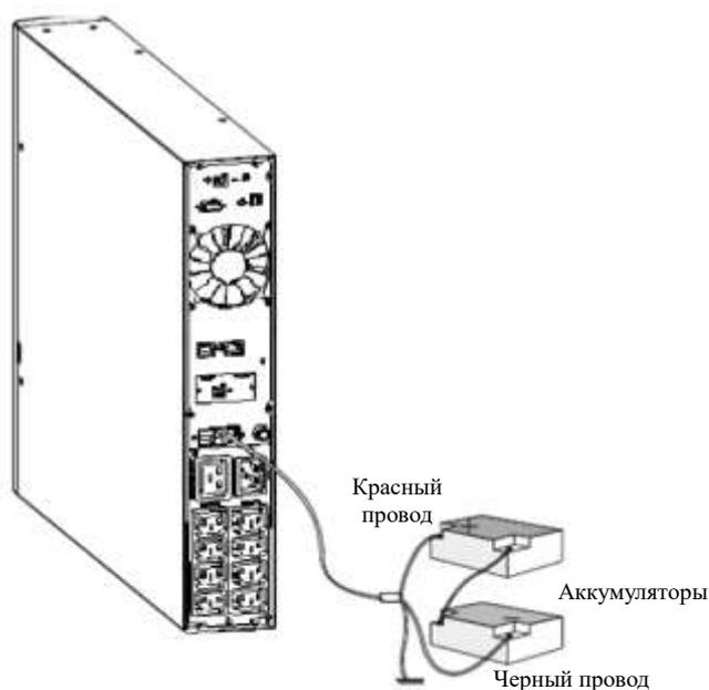
Рисунок 14 Подключение внешних батарей к ИБП с увеличенным временем работы
