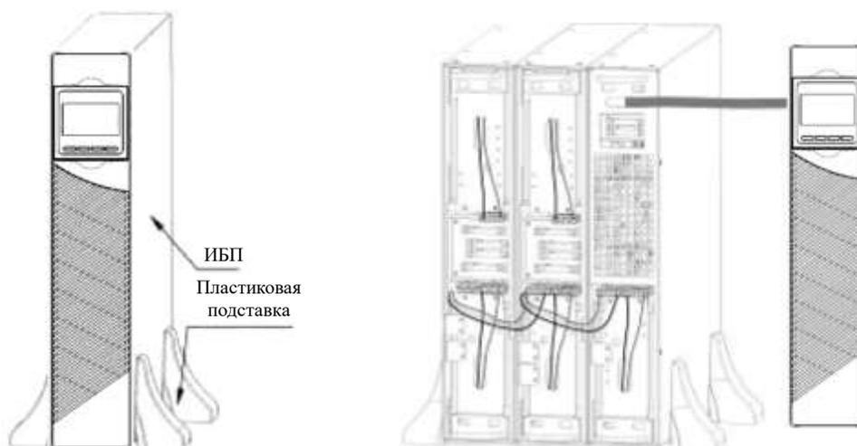
Рисунок 12 Напольная установка ИБП и батарейных блоков
