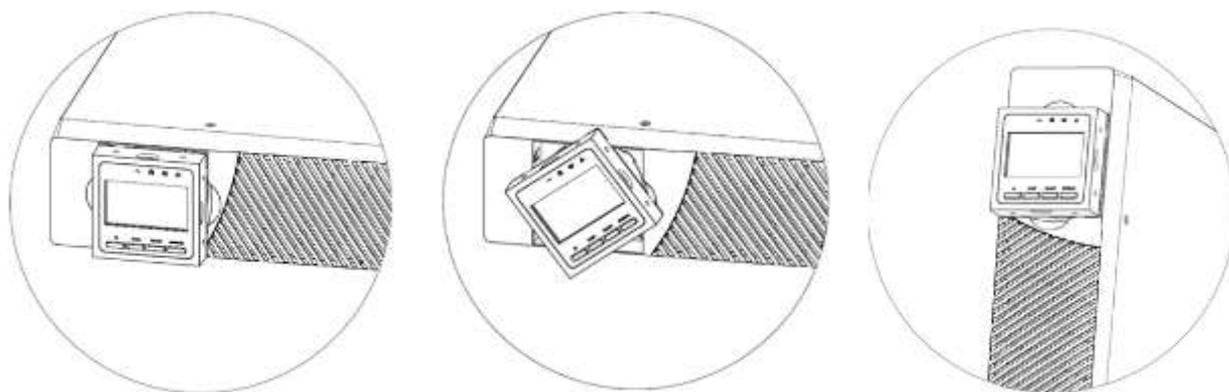
Рисунок 11 Поворот ЖК-дисплея ИБП при напольной установке
