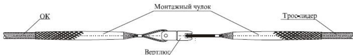
Рис. 2 Схема установки компенсатора кручения (вертлюга)
