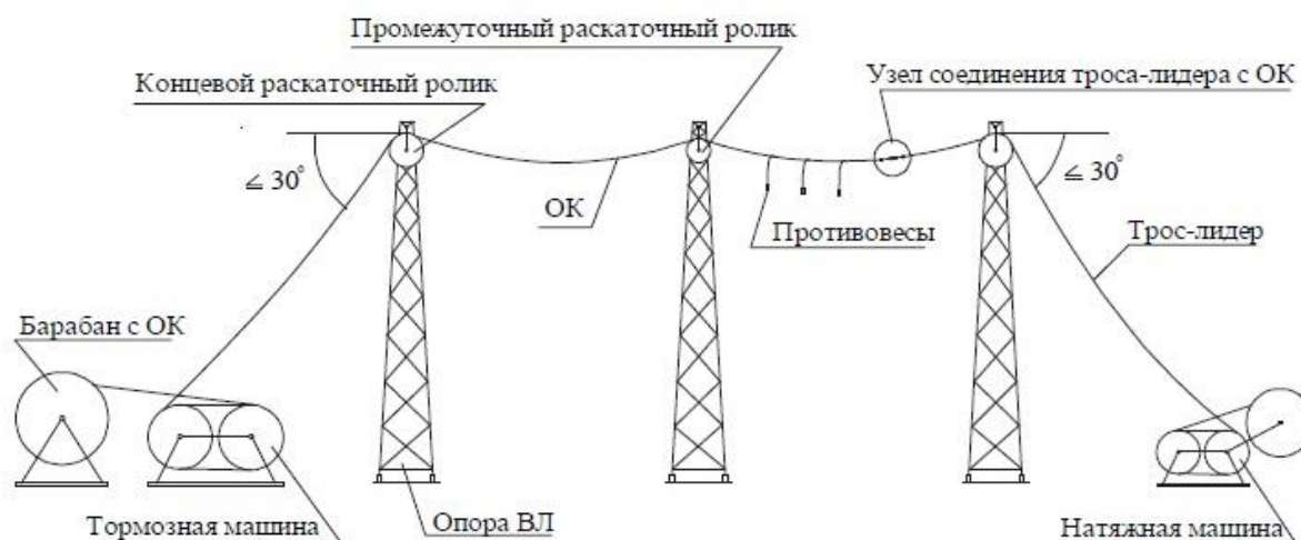
Рис. 3 Схема раскатки ОК
