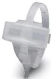
Пластмассовая маркировка для кабелей диаметром от 10 до 25 мм, маркировка производится с помощью вставных полос ESL..., EST или листов большого формата ES/LP-BW-GB, размер маркировочного поля: 29 x 8 мм
